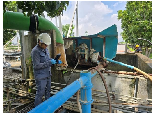
การตรวจวัดการแพร่กระจายอุณหภูมิน้ำหล่อเย็น (เมื่อวันที่ 2 ตุลาคม 2567)
